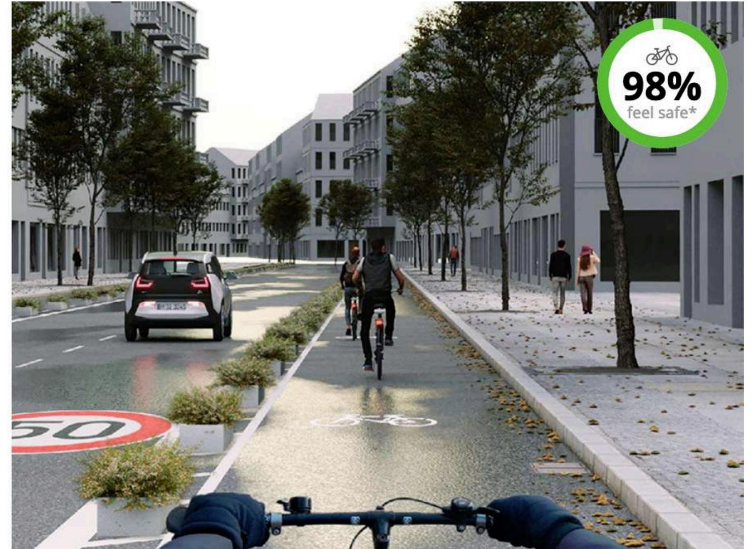
Mit 98,38 % am sichersten bewertete bauliche Trennung bei breiter RVA ohne Grüneinfärbung. Die Variante mit Grüneinfärbung kommt auf 99,11 %
